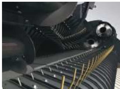
Lisy s řezacím ústrojím jsou rovněž vybaveny hranatými šnekovými dopravníky, které zajišťují rovnoměrné podávání materiálu k rotoru ProCut.
