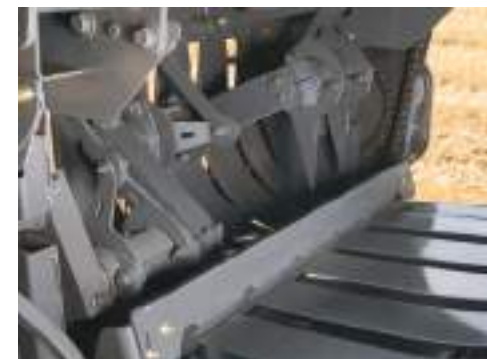
Pěchovací prsty zajišťují rovnoměrné podávání materiálu do předlisovací komory.
