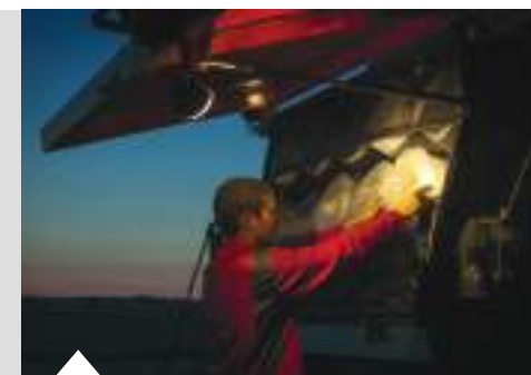
Osvětlení zásobníku motouzu pro snadné doplňování motouzu v nočních hodinách.
