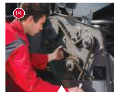
Kontrola stavu napnutí řetězů sběracího ústrojí.
