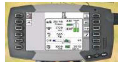
Automatická regulace hustoty s použitím monitorovacího systému lisu C1000.
