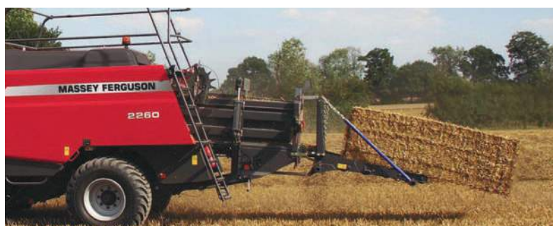
Integrovaný vážicí systém balíků váží balíky, které jsou přepravovány z lisovací komory na vykládací rampu.
