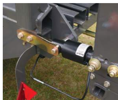
Vysoce přesné siloměry integrovaného vážicího systému balíků.
