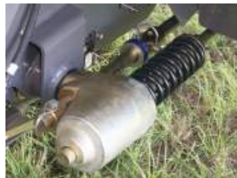
Odpružení sběracího ústrojí s přitlačnými pružinami je určeno pro práci při vysokých rychlostech.
