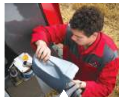
Doplňování oleje do automatického mazacího ústrojí řetězů.
