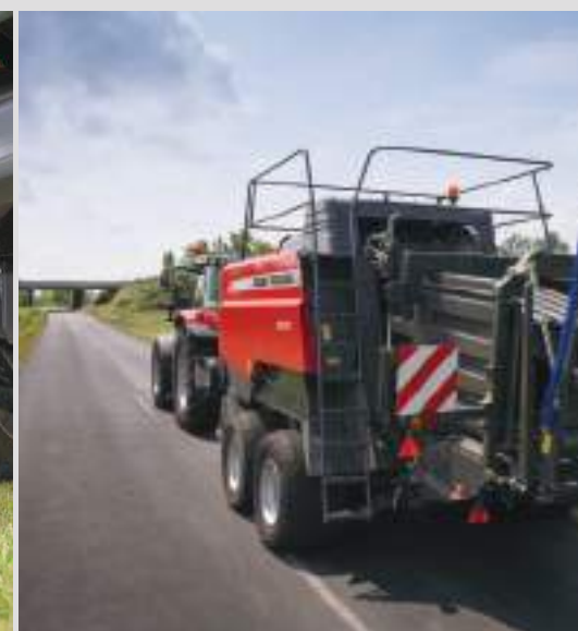
Dvojitá náprava umožňuje vysoké pojezdové rychlosti a vynikající jízdní komfort mezi poli.
