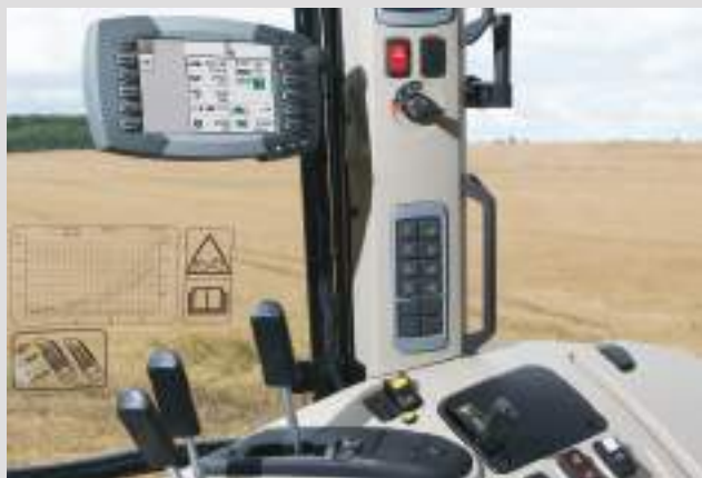
Monitorovací systém lisu C1000.
