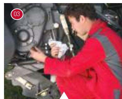
Kontrola hladiny oleje v převodovce řezacího ústrojí.
