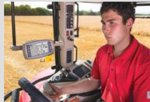
Řízení lisu přes terminál traktoru ISO VT.
