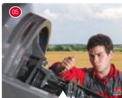
Seřizování kluzné spojky setrvačníku.
