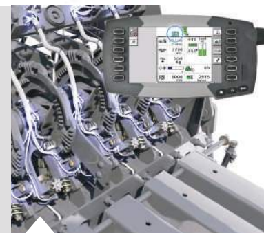
System AutoLube pro menší nároky na údržbu a vynikající spolehlivost uzlovače.
