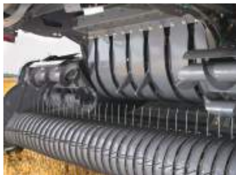
Čtyři hranaté šnekové dopravníky zajišťují větší průchodnost u lisů s pěchovači.
