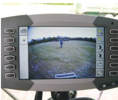
Videokameru lze snadno namontovat na váš lis s připravenou kabeláží. Monitorovací systém lisu C1000 je plně kompatibilní s barevným videosignálem a je součástí standardní výbavy.
