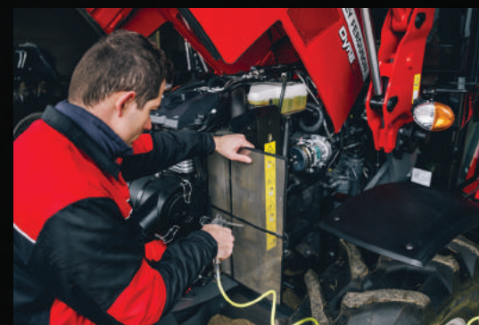
Chladičí zařízení je snadno přístupný, takže jeho čištění je rychlejší a jednodušší.
