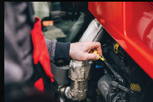
Konstrukce přední nápravy a štíhlé kapoty usnadňují přístup k měrci oleje a filtru.
