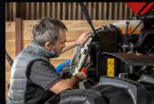
Chladicí zařízení je snadno přístupný, takže jeho čištění je rychlejší a jednodušší.
