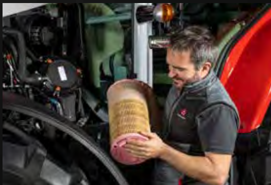
Vzduchový filtr motoru je přístupný a snadno se čistí.
