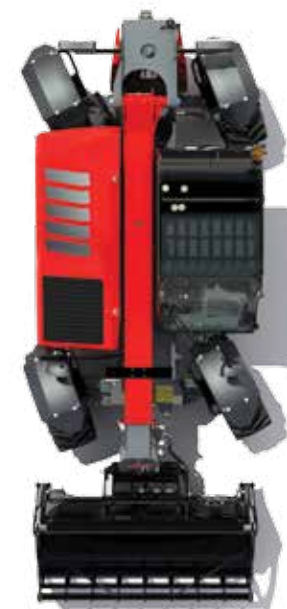
Krabí chod - pro efektivní plnění a vyrovnávání terénu, pro práce podél stěn a v omezených prostorech.
