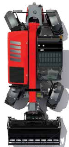
Režim řízení čtyřmi koly pro minimální poloměr otáčení.
